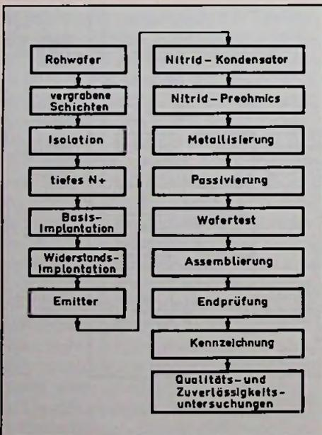
**Bild 2: MONOMAX-Fertigungsverfahren für 100 mm-Wafer**
